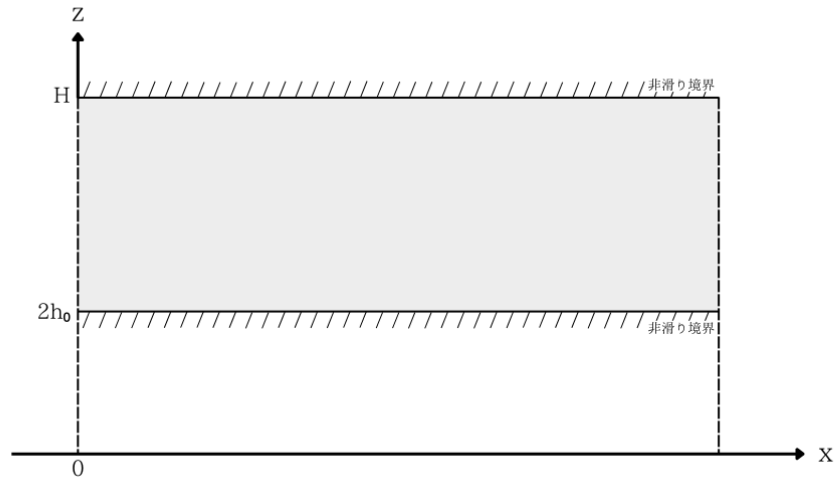
図 B1 h(x) = 2h_0 のときの境界条件
